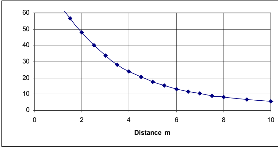
Şekil 6: Açık kasa konteyner yanarken ısı ışıınımı - mesafe ilişkisi
